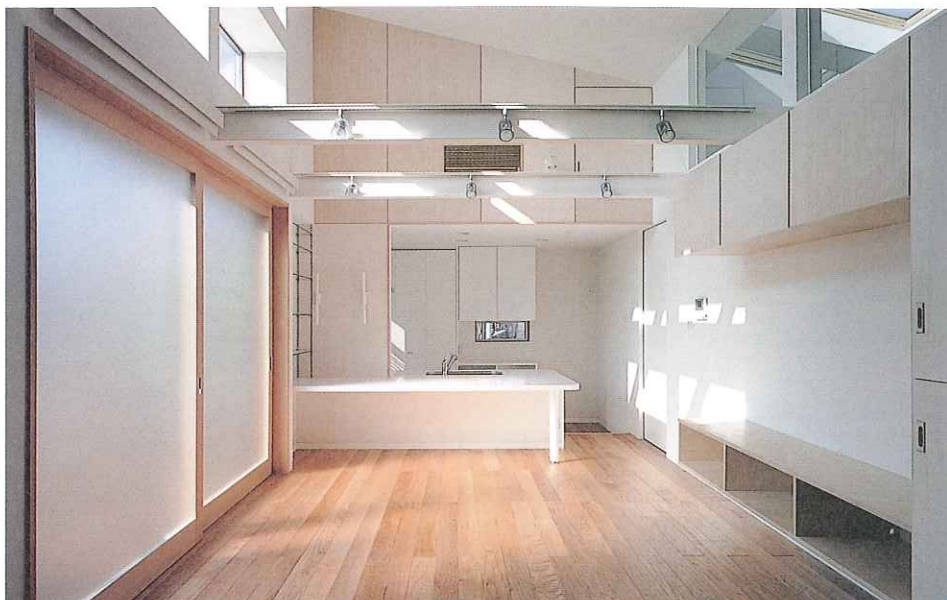
天窗からも光が差し込む子世帯のリビングダイニング。照明は天井の鉄骨梁に取り付けたスポットライトだが、夕方近くまで照明を灯す必要がないほど明るい。部屋の中心に間仕切りを入れれば簡単に個室がつけられるように配慮している
